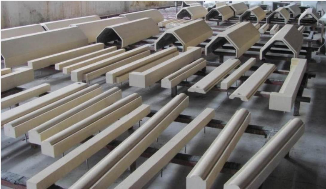
GRC构件即GRC建筑细部装饰构件。规范的简称即GRC建筑细部即GRC建筑细部装饰构件由于名称太长，不便于记忆，常被简称为GRC构件。由于这些年欧陆风情盛行，市场上也常称之为GRC欧式构件即GRC罗马柱即GRC檐线即GRC装饰线条即GRC角线即GRC门窗套即GRC浮雕即GRC花瓶栏杆等。依据建设部颁布的国家标准《建筑装饰装修工程施工质量验收规范》GB50210-2001材料：国家建材行业标准《玻璃纤维增强水泥即GRC即装饰制品》JC/T940所包含的内容；设计：欧内斯特·伯登(Burden.E)《世界典型建筑细部设计》一书中所描述的那些具有美学价值的建筑元素。
